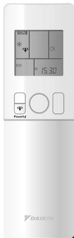
Le mode PUISSANT accélère l'effet de rafraîchissement (chauffage) quel que soit le mode de fonctionnement sélectionné. Vous pouvez bénéficier de la capacité maximale.
